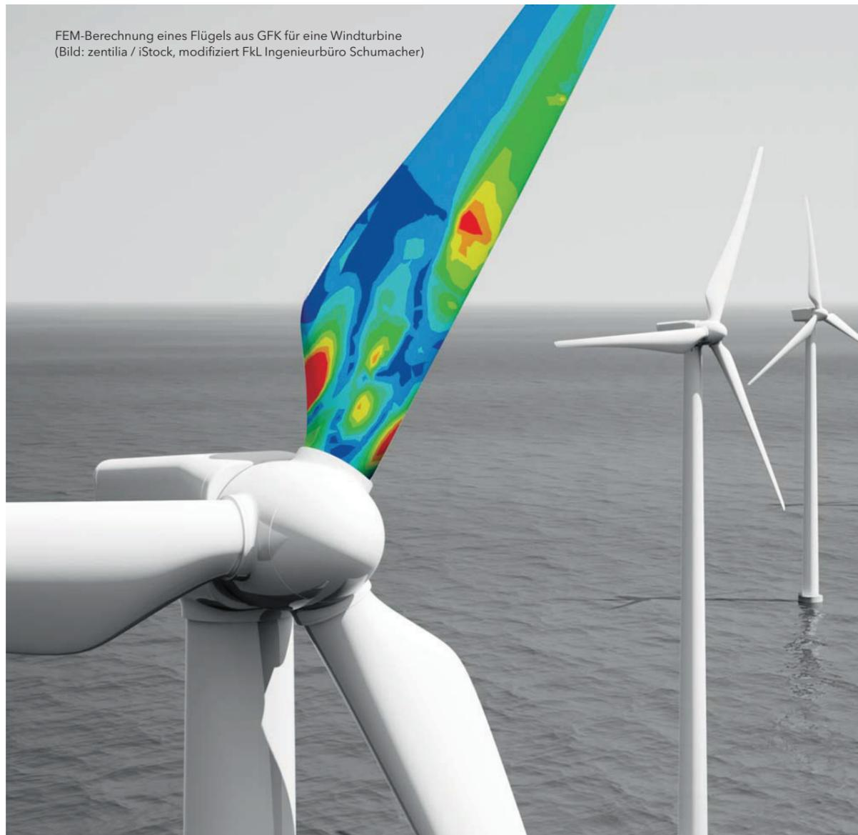
FEM-Berechnung eines Flügels aus GFK für eine Windturbine
